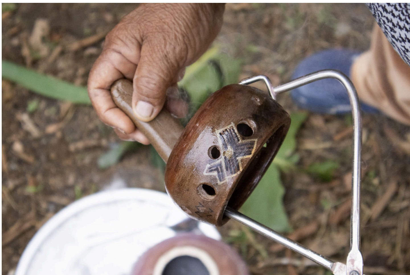
"Sellado post-cocción con material vegetal aplicado en caliente. El acabado aporta brillo y protección superficial."
